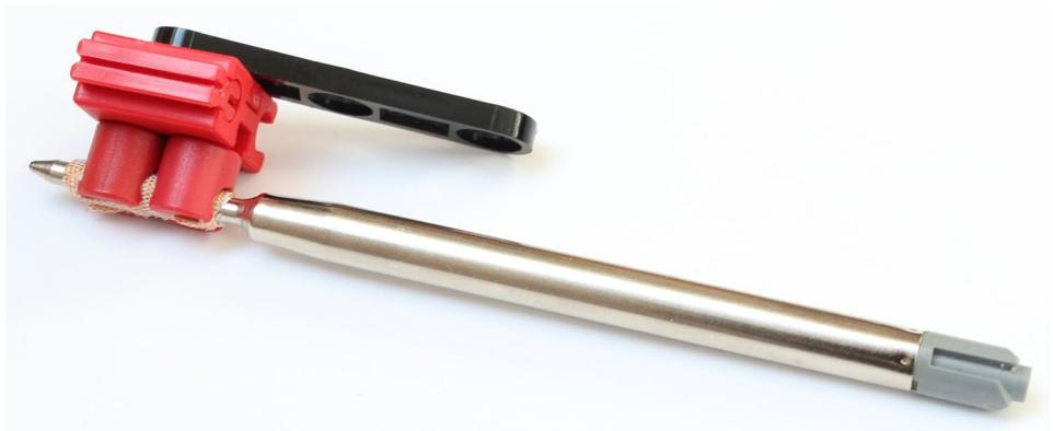
Abb. 5–15 Großraum-Kugelschreibermine in Klemmhülsen
