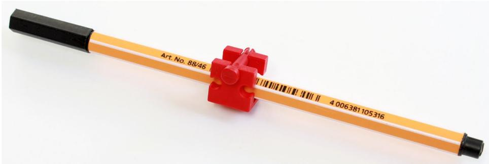
Abb. 5–14 Rollenlager als Halterung für Fineliner
